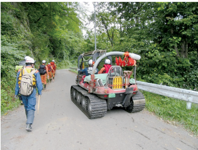
水陸両用バギーによる資機材等の搬送 (岩泉町岩泉地区 塩釜地区消防事務組合消防本部提供)
